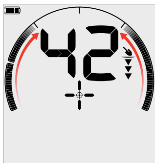
สัญญาณวัตถุเป้าหมายที่อ่อน/อ่อนออกศูนย์กลาง: เปิดเซกเมนต์ความสามารถในการคัดแยกโลหะเบื้องต้น วัตถุเป้าหมายอยู่ใกล้กับด้านนอกของขดลวดมากขึ้น
